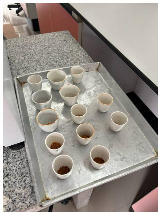
ภาพที่ ข-16 การเตรียมตัวอย่างในถ้วยวิเคราะห์ก่อนขั้นตอนให้ความร้อน/เผา
