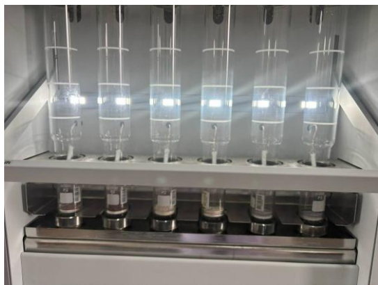
ภาพที่ ข-13 ระบบหลอดย่อย/กลั่นสำหรับการวิเคราะห์ทางเคมีของตัวอย่าง
