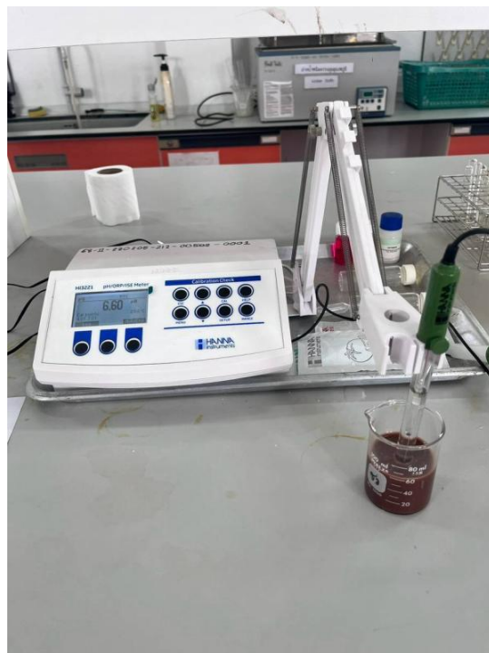
ภาพที่ ซ-18 การตรวจวัด pH ของตัวอย่างผลิตภัณฑ์ด้วย pH meter
