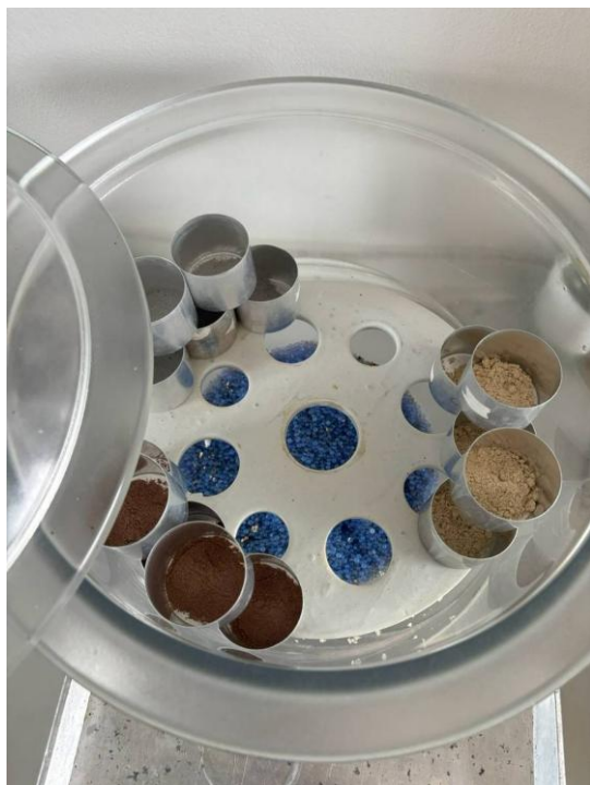
ภาพที่ ซ-17 การเตรียมตัวอย่างภายในโถดูดความชื้นเพื่อควบคุมสภาวะก่อนชั่ง
