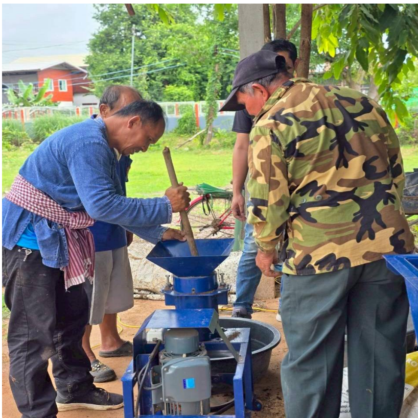
ภาพภาคผนวกที่ 31 การอัดเม็ดมูลโคหลังจากที่มีการหมัก
