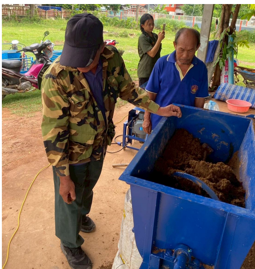
ภาพภาคผนวกที่ 28 การตีปนมูลโคที่หมักเสร็จแล้วให้มีความละเอียดมากขึ้นก่อนที่จะอัดเม็ด
