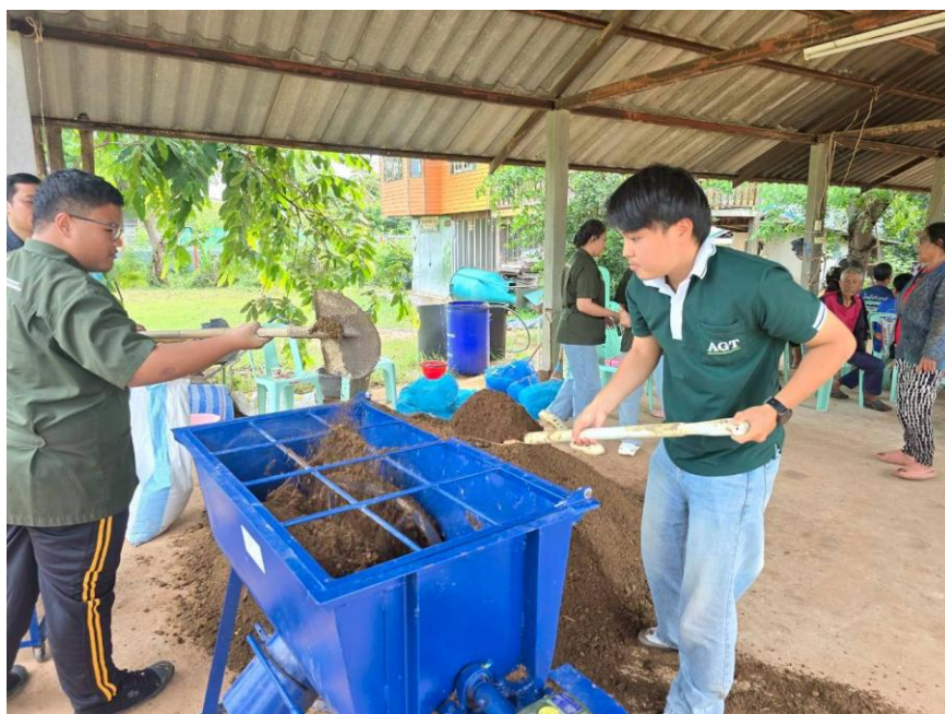
ภาพภาคผนวกที่ 30 การตีป่นมูลโคที่หมักเสร็จแล้วให้มีความละเอียดมากขึ้นก่อนที่จะอัดเม็ด
