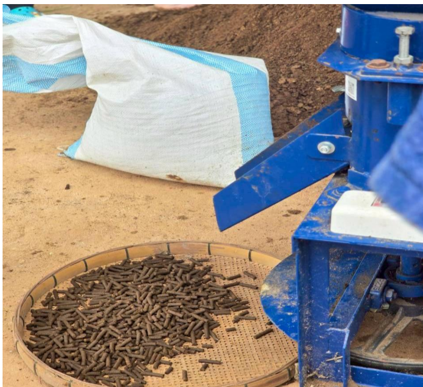
ภาพภาคผนวกที่ 32 การอัดเม็ดมูลโคหลังจากที่มีการหมัก
