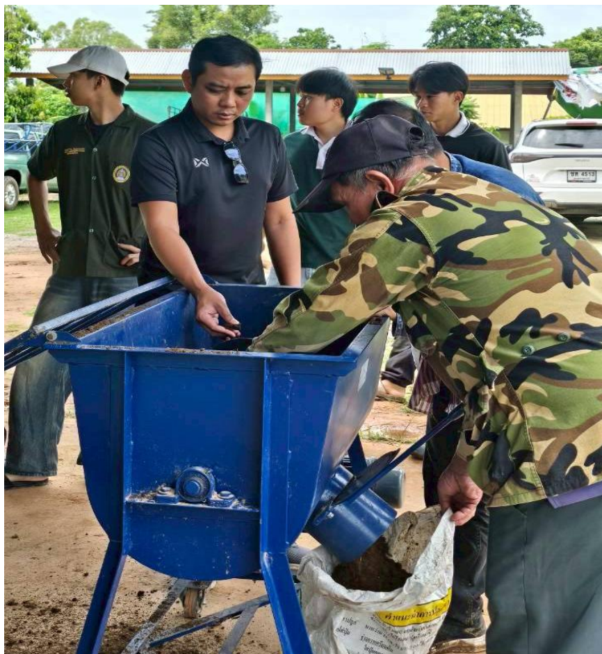
ภาพภาคผนวกที่ 29 การตีป่นมูลโคที่หมักเสร็จแล้วให้มีความละเอียดมากขึ้นก่อนที่จะอัดเม็ด
